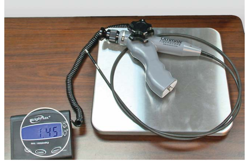
منظار فيبرسكوب بالكامل مع لمبة الدليل و البطارية في المقبض وجاهز للاستخدام الوزن 1.45 رطل مايعادل ( 0.65 كيلوجرام)
