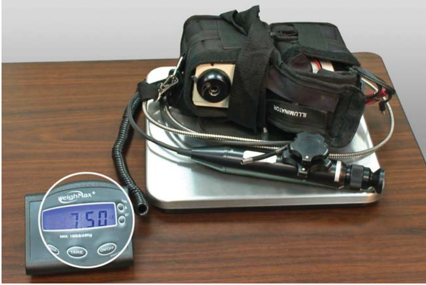
يحتوي صندوق منظار فيبرسكوب الكامل على بطارية ولمبة دليل ذات اضاءة قوية - والتي يحملها المشغلي اثناء عملية التفتيش الوزن 7.5 رطل مايعادل ( 3.40 كيلوجرام)
